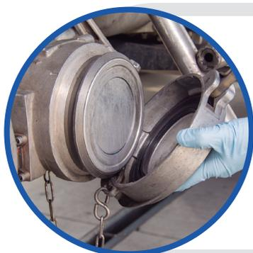
6. Instalar el accesorio de descargue para la toma de la muestra.
