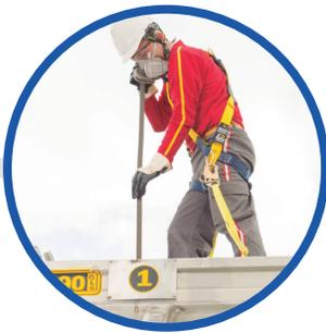
12. Realizar la medición de los compartimientos del vehículo teniendo en cuenta todas las medidas de seguridad necesarias para la ejecución de la actividad (trabajo en alturas).
