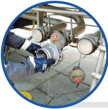
8. Abrir la válvula de descargue lentamente y dejar caer el producto al balde por 10 segundos, esto hará que la presión se disipe gradualmente y se evitará un derrame de producto. Seguidamente se tomará la muestra.
