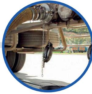
8. Se requiere colocar la bandeja de control de derrames o elemento de contención debajo de la conexión del carrotanque y la manguera de descargue.
