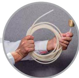
Sonda transparente con pesa de bronce para realizar la succión del producto y tomar la muestra del fondo del tanque.
